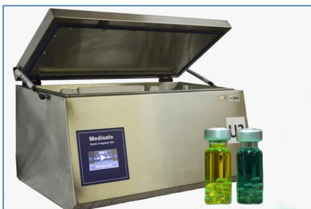
**Figura 9** – Imagem da solução utilizada como medidor de limpeza utilizado para monitorar o nível de energia ultrassônica da lavadora.
