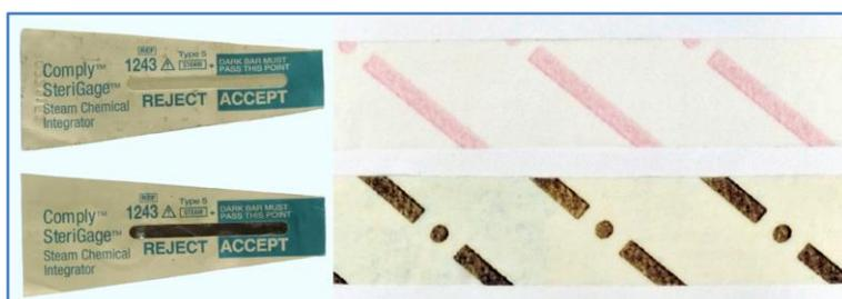
**Figura 17** – Imagem do integrador químico utilizado dentro das caixas cirúrgicas e o indicador externo dos pacotes. A alteração da cor ocorre após o processo de esterilização.
