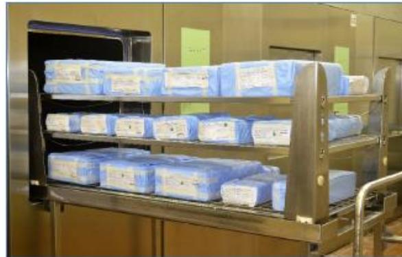
Figura 14 – Imagem do rack montado para esterilização do material na autoclave
