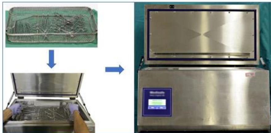
Figura 5 – Imagem do material que após a pré-limpeza é colocado no cesto de inox e acoplado a lavadora ultrassônica.
