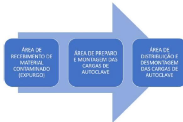
Figura 1 – Fluxo de material unidirecional dividido em três áreas separadas por barreiras físicas.
