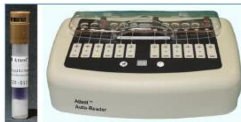
Figura 16 – Imagem do indicador biológico utilizado na incubadora para verificar a eficiência da esterilização.
