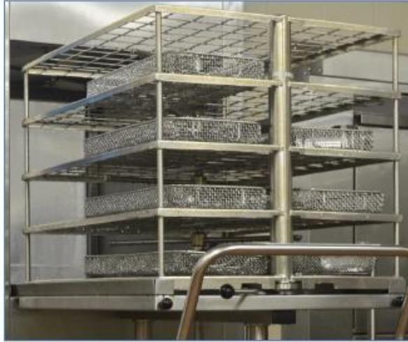
Figura 6 – Imagem dos cestos de inox com o material para inserir na lavadora termodesinfectora.
