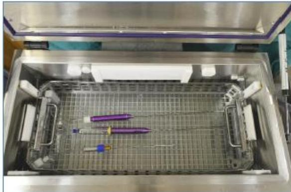
Figura 7 – Imagem dos conectores para limpeza de materiais com lúmens que são utilizados na lavadora ultrassônica.
