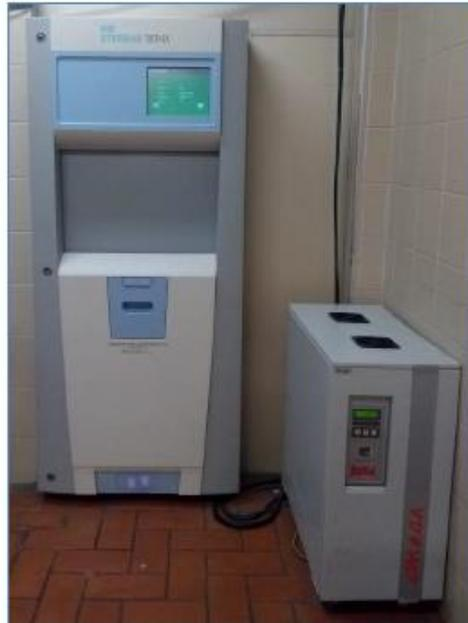
Figura 18 – Imagem do equipamento utilizado na esterilização de peróxido de hidrogênio.
