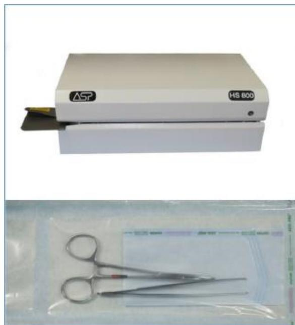
Figura 13 – Imagem da seladora e do material embalado no grau cirúrgico e selado.
