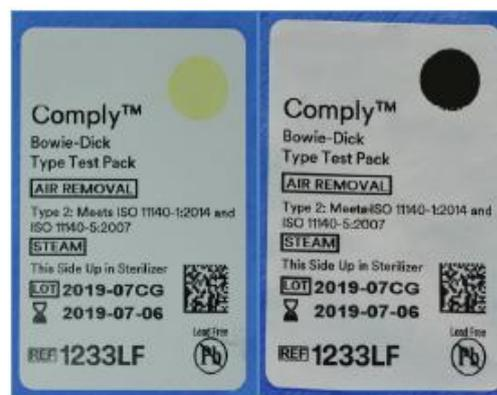
Figura 15 – Imagem do teste de Bowie-Dick. A cor muda do amarelo (antes da esterilização) para o preto (após esterilização).
