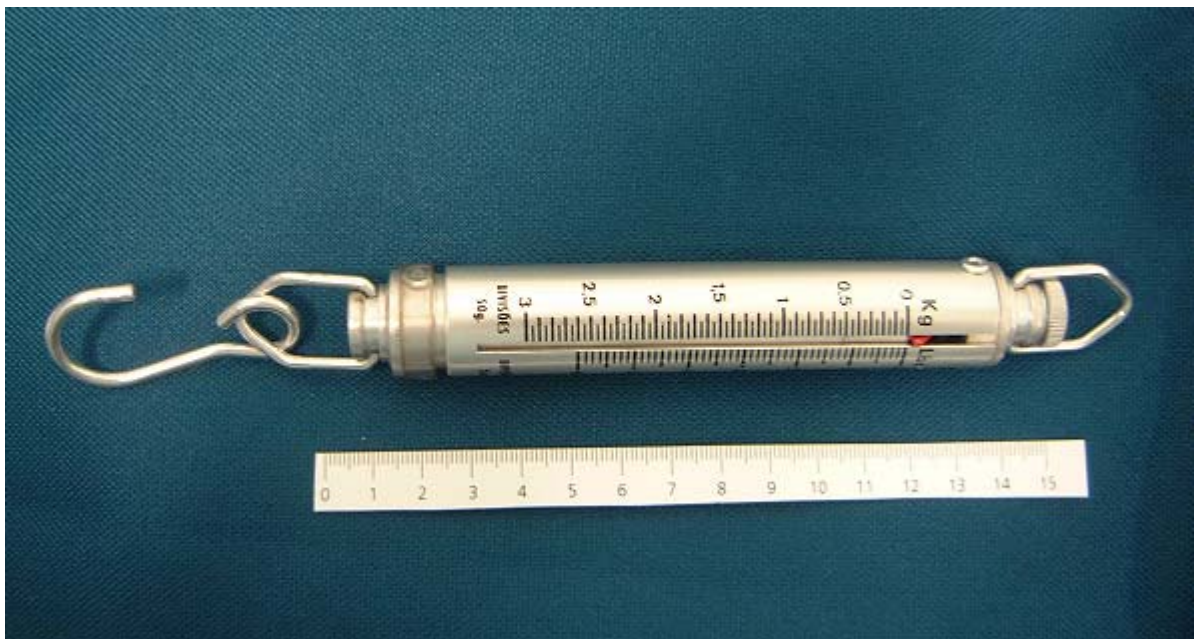
Figura 5 – Dinamômetro, utilizado nas medidas de tração, com capacidade medidora máxima de 3 kgf e divisões a cada 50 gf.
