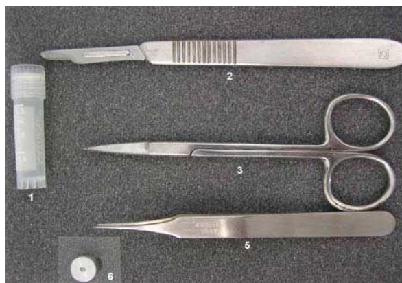
Figura 8 - Materiais utilizados para preparo das amostras: tubo criogênico, bisturi e lâmina #15, tesoura de Íris, Pinça de Addison com dente, Porta-Amostra de alumínio e lamínula de vidro
