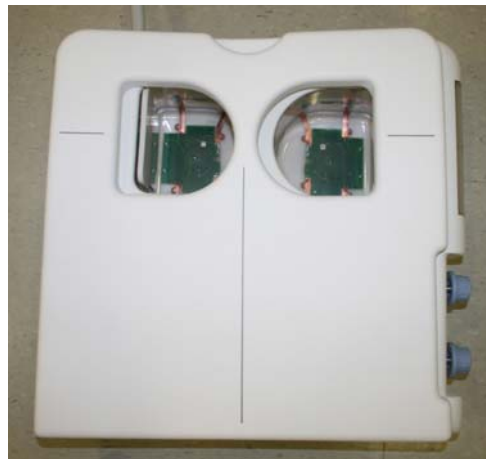
FIGURA 10: Bobina de sinergia de quatro elementos utilizada para a aquisição de imagens na ressonância magnética.
