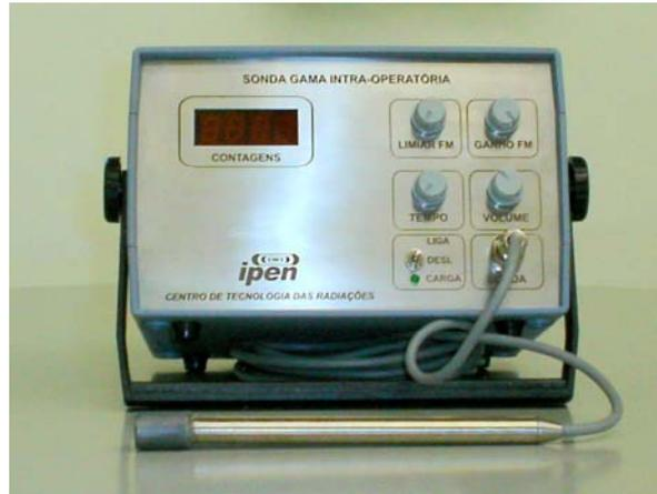
Figura 5 – Equipamento de Detecção Gama Intra-operatória (DGI) brasileiro (IPEN).
