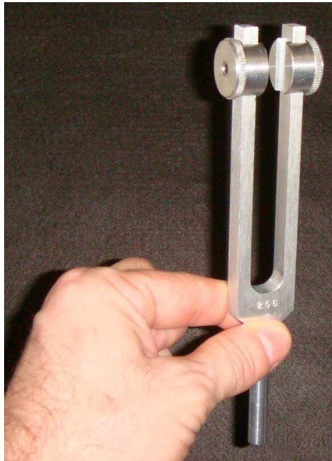
FIGURA 6 - Diapasão de alumínio maciço de 256Hz, com cursores.
