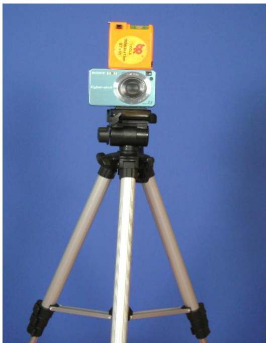
Figura 6 – Disposição do tripé-trena com nível bolha de ar e câmera com fotograma no plano horizontal.
