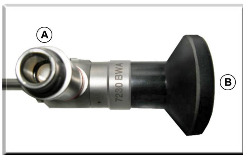
FIGURA 3. Endoscópio rígido. (A) Entrada de luz para iluminação da cavidade óptica; (B) Local de acoplagem da microcâmera.
