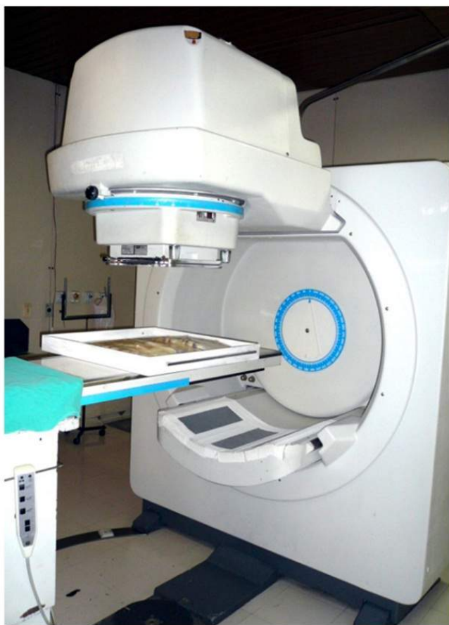
FIGURA 4. Bandeja com os animais, posicionada para a radiação ionizante (RI) no aparelho de telecobaltoterapia.
