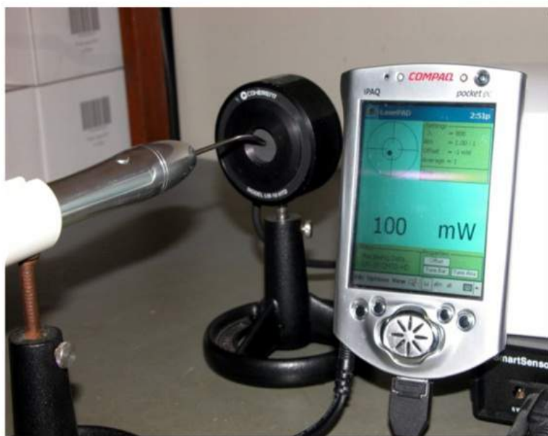
FIGURA 8. Equipamento de LASER durante a calibração.
