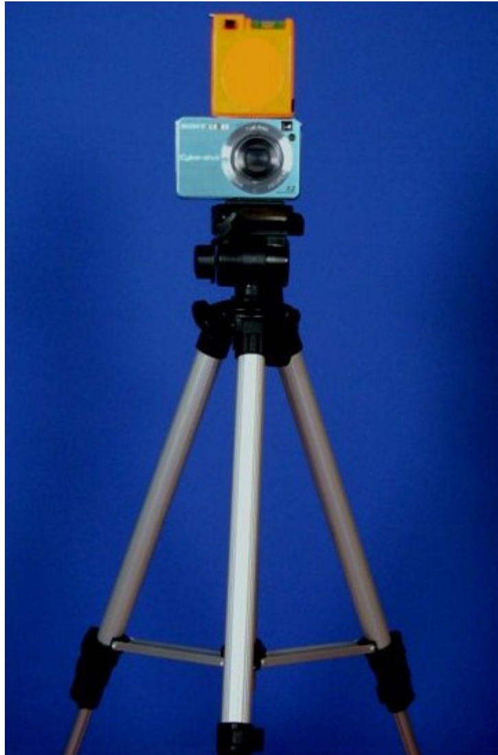
Figura 6. Disposição do tripé, trena com nível bolha de ar e câmera com fotograma no plano horizontal.
