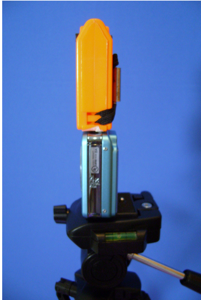
Figura 9. Tripé e câmera fotográfica, duplamente nivelada.
