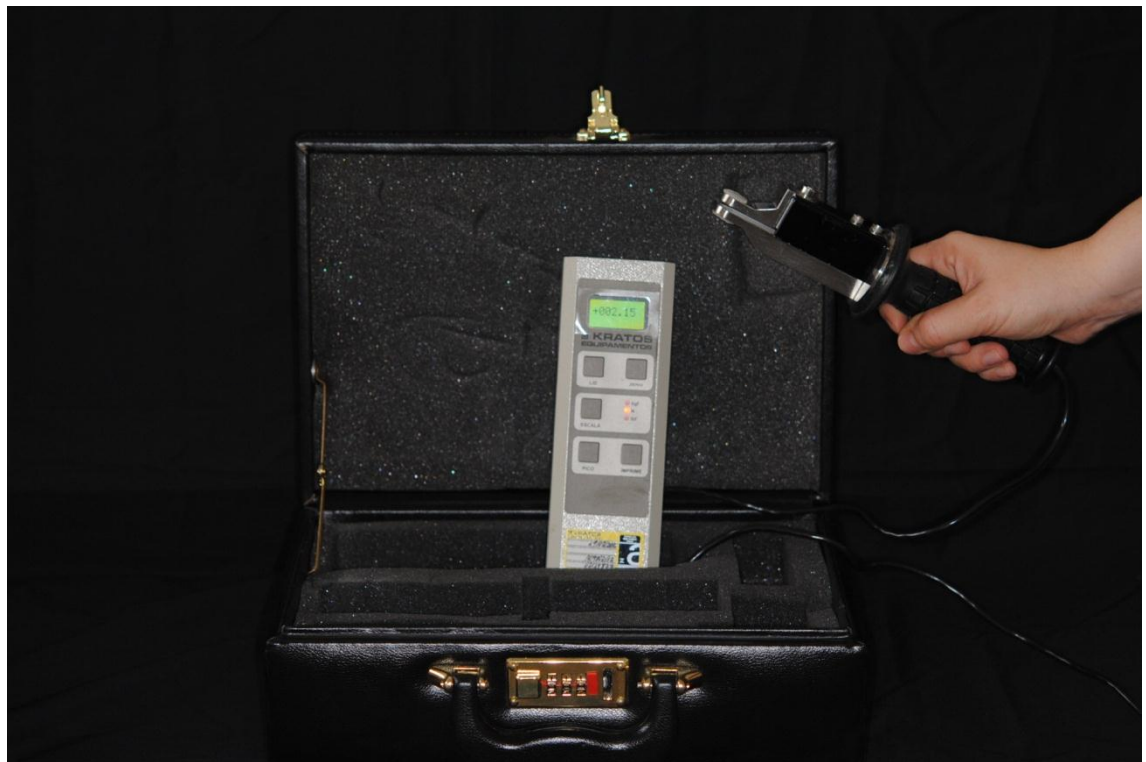
Figura 4 - Dinamômetro digital modelo DDK com capacidade de 100kgf, adaptado para condição oral.
