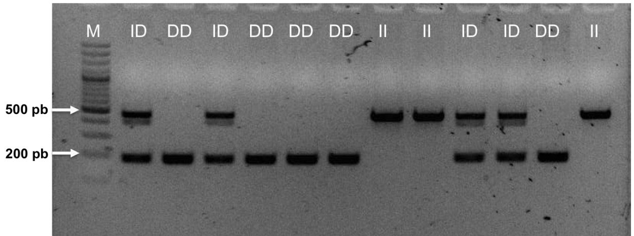
Figura 4 - Eletroforese em gel de agarose 2%; II - Homozigoto para inserção, ID - Heterozigoto, DD - Homozigoto para deleção; M - Marcador de massa molecular 100pb.
