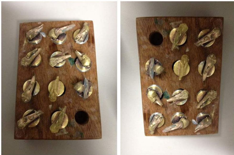
Figura 4 - Dentes seccionados longitudinalmente após serem metalizados, antes de analisados em MEV
