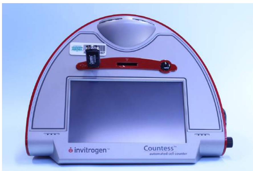
Figura 6 – Contador de células automático (Invitrogen™ - Countess, Seul, Korea) usado para a contagem de células viáveis após o botão de células ser ressuspendido.
