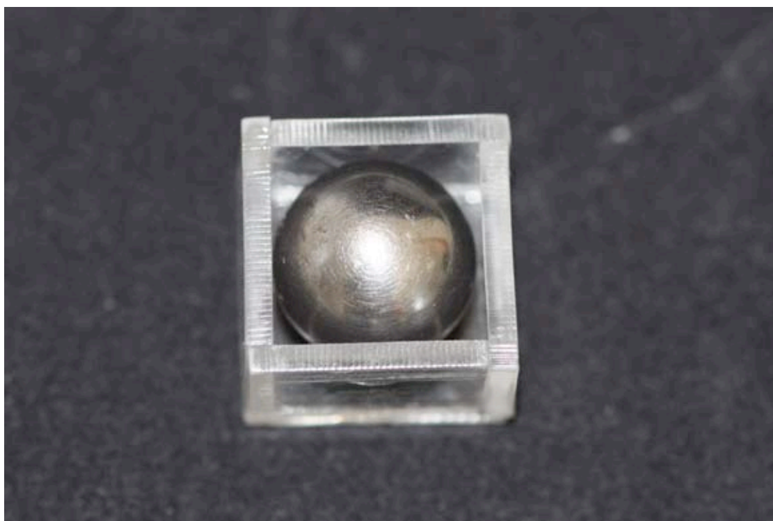
Figura 2 – Cubo de acrílico com dimensões de 2x2x2 cm com esfera de aço inoxidável no seu interior.
