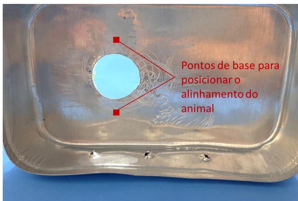
Figura 6 – Parte interna da caixa metálica com marcação dos pontos de alinhamento do animal.
