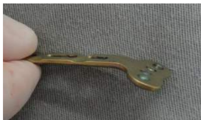
Figura 62. Placa com quebra de todos os parafusos bloqueados distais.
