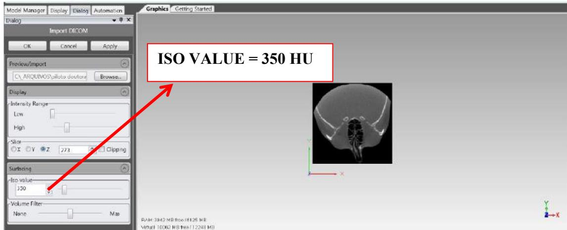
**Figura 10.** Importação da TC representando o tecido ósseo a ser importado com valor do limite inferior pré fixado em 350 unidades de *Hounsfield* (HU).
