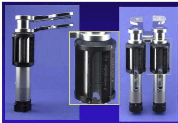
Figura 8. Tensiômetro ( DePuy Orthopaedics Inc., Warsaw, IN, USA ). HIGUCHI et al (2009).
