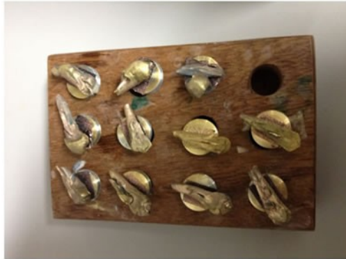
Figura 10 - Dentes seccionados longitudinalmente após receberem ouro coloidal, antes de serem observados em MEV.
