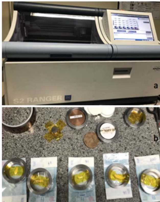
Figura 13 - Aparelho da Bruker, o FRX S2 Ranger é utilizado para identificar composição de amostras sólidas e preparo de porta amostras para FRX: a- FRX S2 Ranger; b- Porta amostras.
