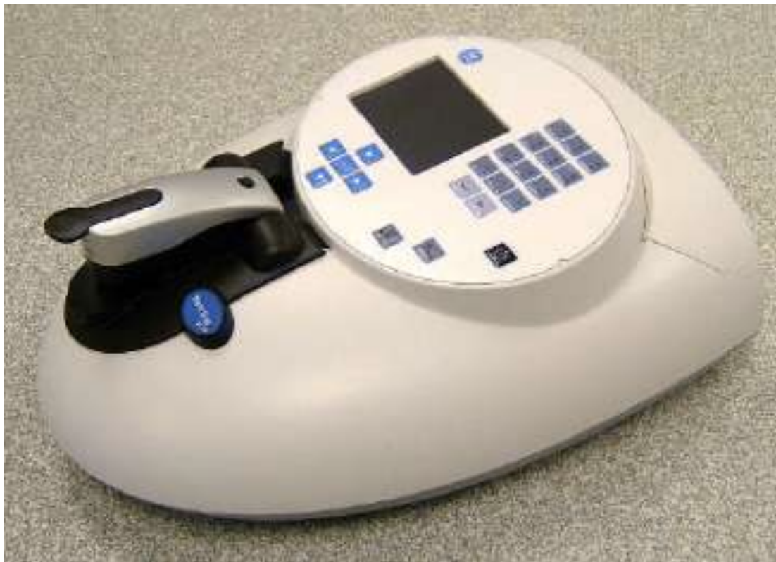
Figura 8: Espectrofotômetro NanoDrop para determinar a concentração e o grau de pureza do RNA
